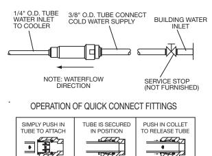
PUSHING TUBE IN BEFORE PULLING IT OUT HELPS TO RELEASE TUBE
