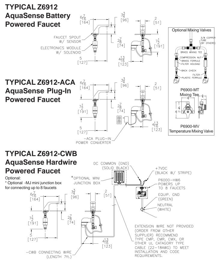
NOTE: MUST USE EITHER ZURN P6000-HW6 HARDWIRE POWER CONVERTER OR ZURN P6000-PC6 PLUG-IN POWER CONVERTER TO ENSURE PROPER OPERATION. USING A POWER CONVERTER OTHER THAN ZURN MAY RESULT IN OPERATION MALFUNCTION OR UNIT FAILURE.
