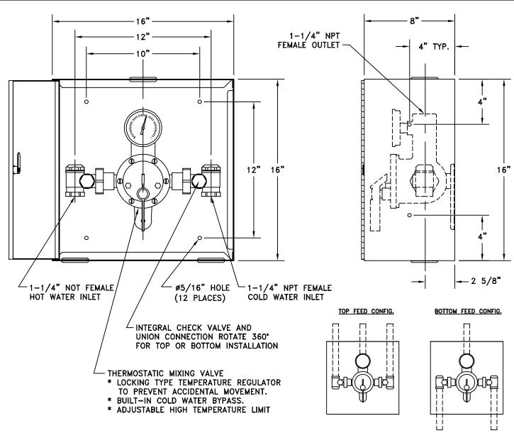
NOTE: ENCLOSURE IS 16 GAUGE BRUSHED STAINLESS STEEL CABINET WITH HINGED DOOR AND KEYED LOCK.
