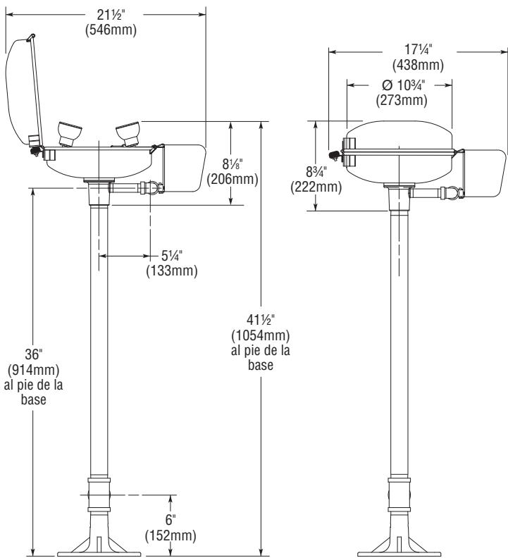
**NOTA:** Todas las dimensiones asumen el enganche de rosca estándar. Las variaciones en la fabricación permiten +/- 3,1 mm ( $\frac{1}{8}$ ") por junta roscada. Para encontrar la tolerancia de una dimensión, agregue el número de juntas roscadas entre una dimensión y multiplíquelo por 3,1 mm ( $\frac{1}{8}$ ").
