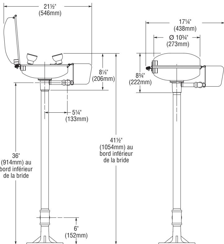
*Note : Toutes les dimensions supposent un engagement de filetage standard. Les variations de fabrication prévoient +/- 3,1 mm ( $\frac{1}{8}$ ") par joint fileté. Pour trouver la tolérance d'une dimension, ajouter le nombre de joints filetés entre une dimension et le multiplier par 3,1 mm ( $\frac{1}{8}$ ").*
